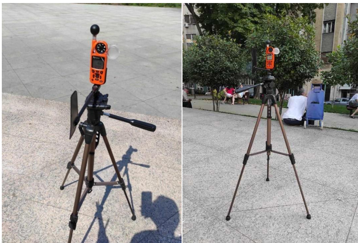
Slika br. 1: Mikrometeorološko merenje na lokaciji Obilićev venac u Beogradu, uređaj Kestrel 5400 Heat Stress Tracker, fotografisano avgusta 2021.godine, autorka: Milica Lukić
